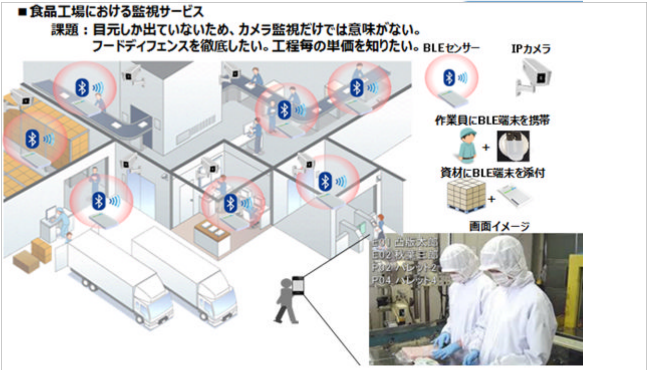
図 2-1. カメラ+ICタグで人時管理と製造コスト管理
